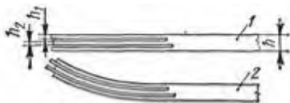
Рисунок 7 - Гнутопропиленные детали с продольными пропилами
