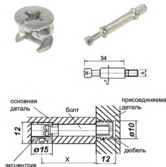
Рисунок 28 - Стяжка эксцентриковая
